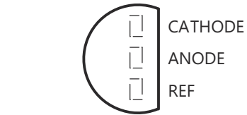
图 4-2. LP 封装 3 引脚 TO-92 顶视图
