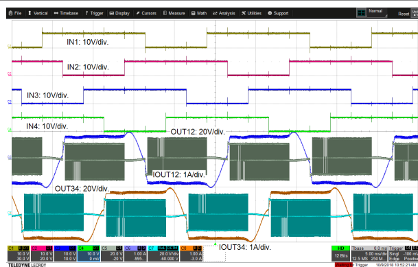
图 8-9. 关断状态制动模式下的步进电机半步运行
